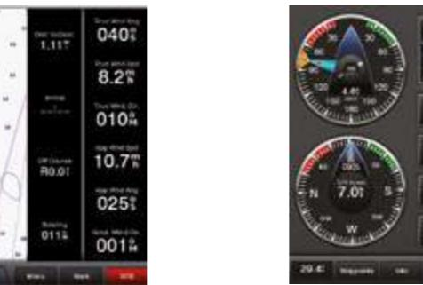
Fonctions Voile : laylines, COG, affichage simultané des données de vent réel/apparent, etc.
