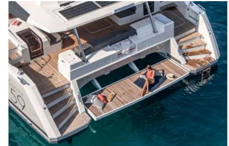
HYDRAULIC PLATFORM PLATEFORME ANNEXE HYDRAULIQUE
